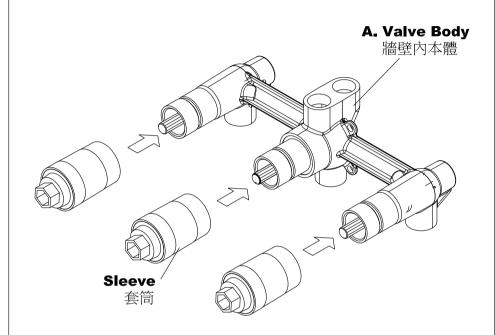
\* Use **Sleeves** to protect the cartridge and thread before installation. 使用套筒保護陶瓷中心栓及螺牙,必須在安裝程序前先套上。
